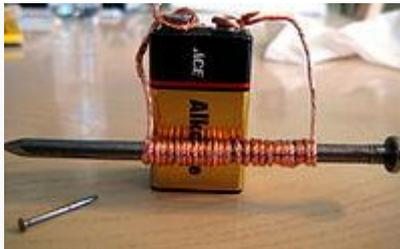
Eletroímã: um exemplo de aplicação da força eletromagnética.
